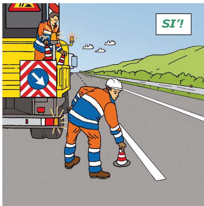
Figura 59 – Posizionamento dei coni o defleco: comportamento corretto
